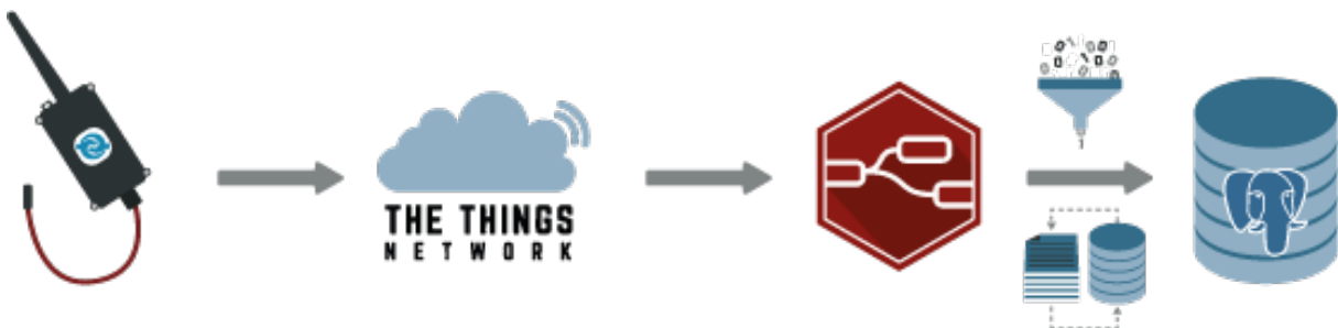
Figuur 1, sensor installeren, database aanmaken en database vullen met data en metadata doormiddel van node-RED
